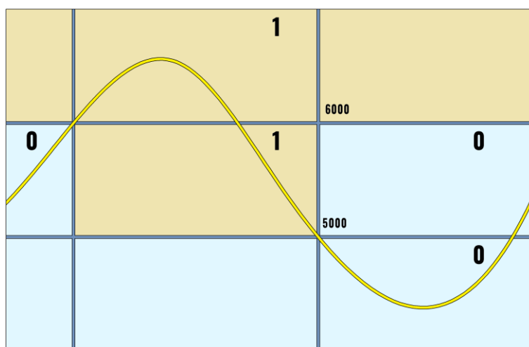
Рисунок 2.10 Преобразование аналогового сигнала в дискретный
